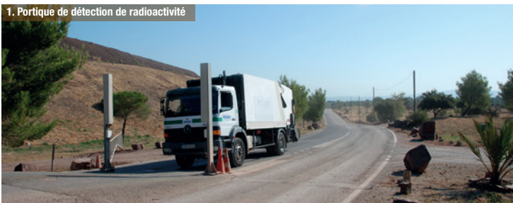
1. Portique de détection de radioactivité
