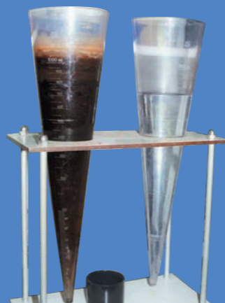
Lixiviats avant et après nano-filtration.
